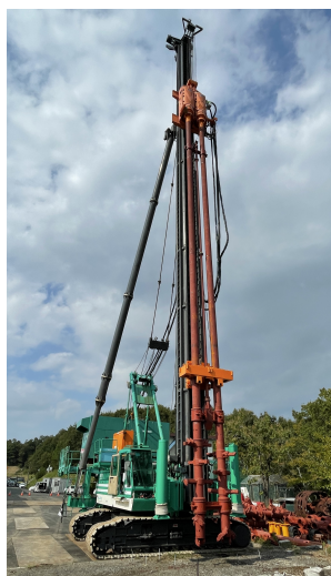
写真-1 深層混合処理機 全景 Fig-1 A general view of a deep mixing machine
